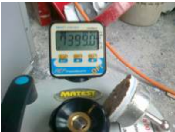
APARAT MATEST carotare, adincime 10 mm pastila de smulgere si valoare masurata
