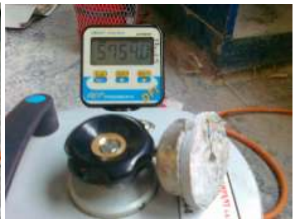
APARAT MATEST carotare, adincime 10 mm pastila de smulgere si valoare masurata
